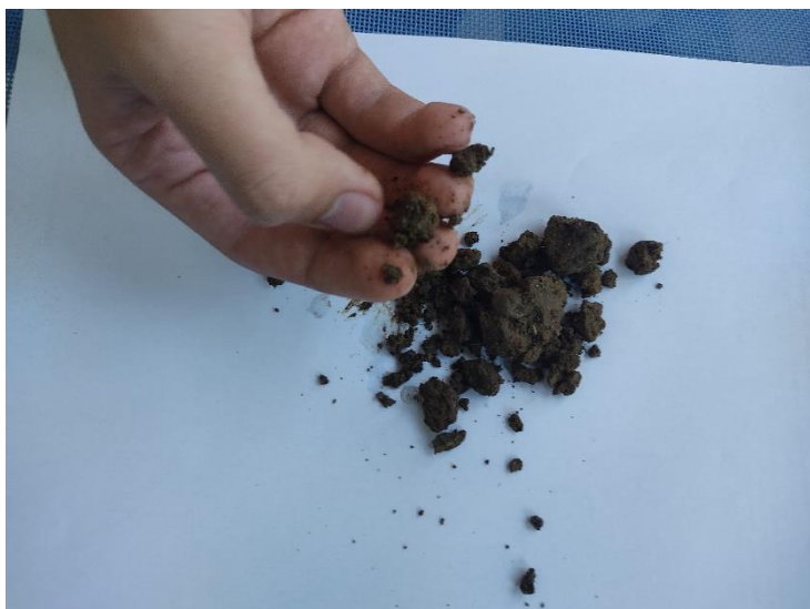
Obr. 2 – Hmatová skúška správania sa pôdnej vzorky č. 1 po miernom navlhčení
