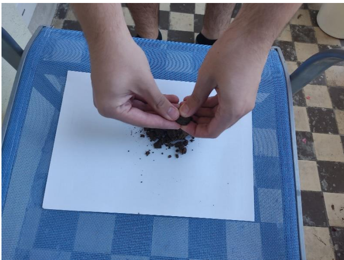
Obr. 1 – Určovanie zrnosti a skeletnosti vzorky č. 1 pomocou hmatovej skúšky
