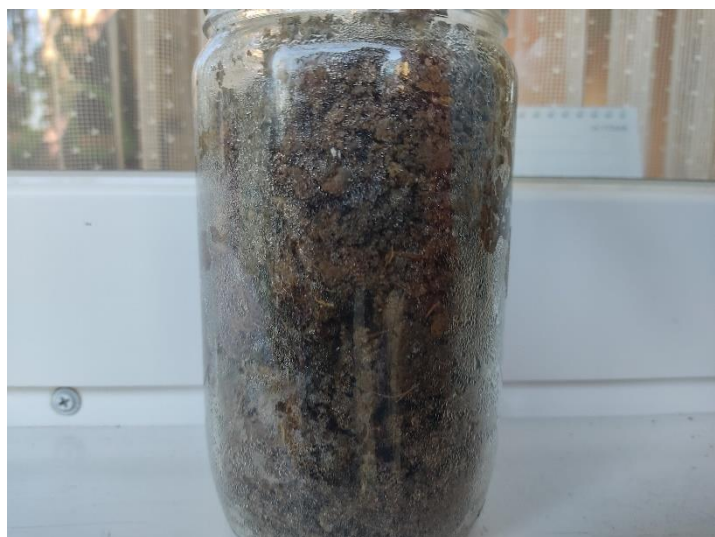
Obr. 6 - Prenikanie vody do vzorky č. 2
