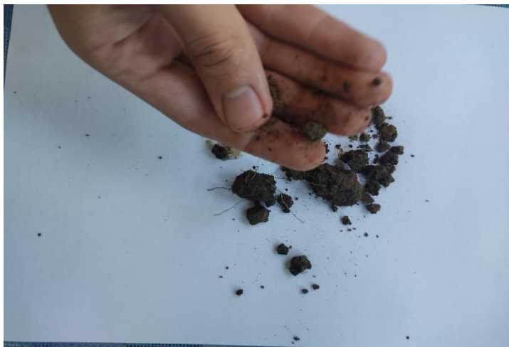
Obr. 5 - Hmatová skúška správania sa pôdnej vzorky č. 2 po miernom navlhčení
