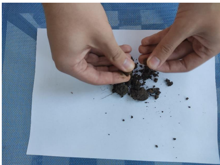
Obr. 4 – Určovanie zrnitosti a skeletnatosti vzorky č. 2 pomocou hmatovej skúšky
