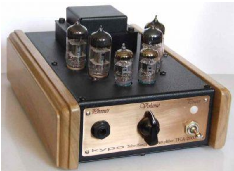
Elektrónkový zosilňovač. Pekne vidno 2 x 3 elektrónky zapojené za sebou.
